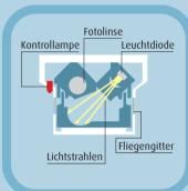
Die Sensoren arbeiten nach dem optischen Prinzip, d.h. in der Messkammer des Rauchmelders werden regelmäßig Lichtstrahlen ausgesendet, die im Normalzustand nicht auf die Fotolinse treffen.
